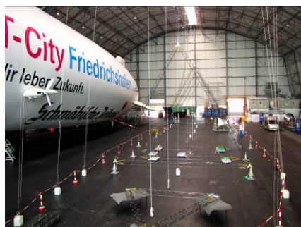
Erste Elemente der Querstruktur wurden montiert, © ZLT.
