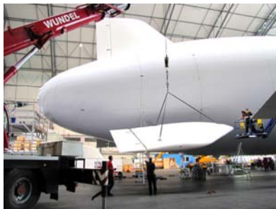
Ein Kran hebt das rechte Leitwerk in Position. Auf dem Steiger nähern sich die Mechaniker, um das Leitwerk an der Zeppelinstruktur zu befestigen.
