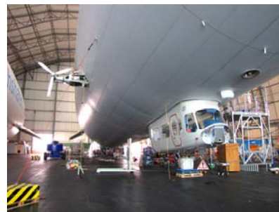
Die meisten Außenkomponenten sind nun befestigt: Passagiergondel, Leitwerke und seitliche Triebwerke.
