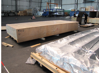
Spezialanfertigung: Transportbox für Zeppelin Längsträger
