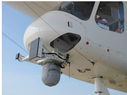
© ZLT Zeppelin NT mit See-Überwachungs-Radar und Hochleistungs-Kamerasystem.
