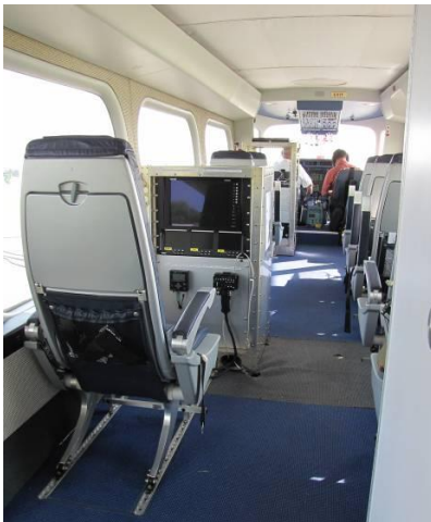
© ZLT Über dieses Camera Command Reck steuert ein Operator die verschiedenen Kameras und zeichnet deren Bildsignale auf.
