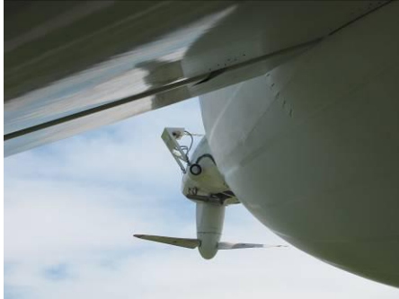
© ZLT GPS-Antennen am Heckantrieb des Zeppelin NT (links)
