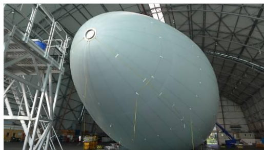
© ZLT Die Hülle für den zweiten Goodyear Zeppelin NT wird in Friedrichshafen einem Drucktest unterzogen.
